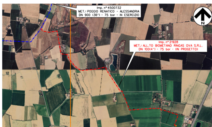
Figura 2.1.1- Ortofoto con individuazione area d'intervento (in blu il metanodotto in esercizio, in rosso il nuovo metanodotto in progetto).
